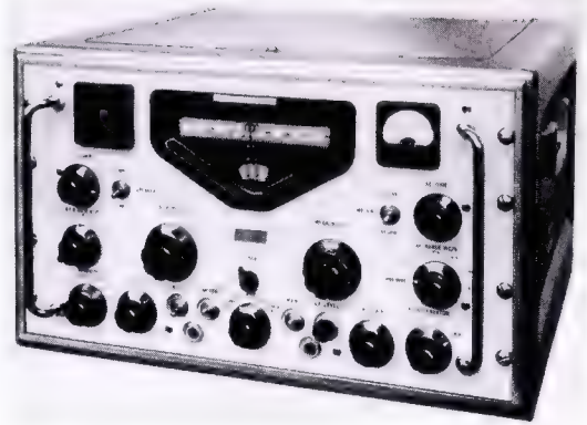
Bild 1. Gesamtansicht des Empfängers Racal RA 17. Rechts Hf- und Nf-Regler, links Bedienungsknöpfe des 2...3-MHz-Empfangsteils. Der linke große Knopf gehört zur Linear-skala (Kilohertz-Einstellung), der rechte große Knopf zur Kreisskala (Megahertz-Einstellung)
